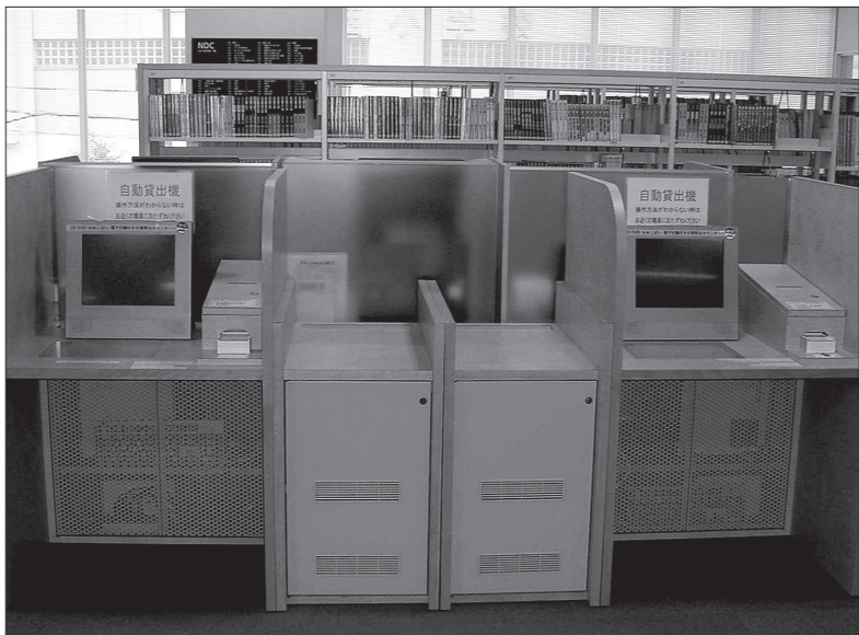
〔資料8〕江戸川区立東葛西図書館に設置されている自動貸出機。モニターの手前、机上にある四角いプレートのようなものがICタグの情報を読み取る。 ●資料6-8の画像提供／内田洋行RFIDソリューション課
